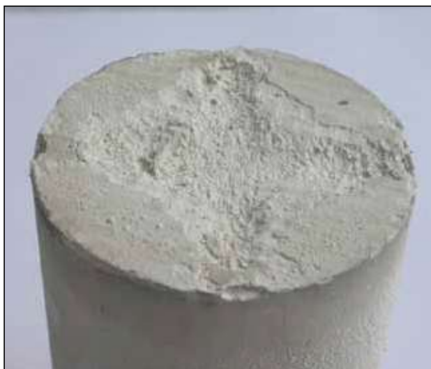
Opløsning. Halfdan-kalkprøven viste tydelige opløsningsgruber på den endeflade, hvor CO 2 -beriget vand blev pumpet ind. Prøvens diameter 28 mm. Foto: Dan Olsen.
