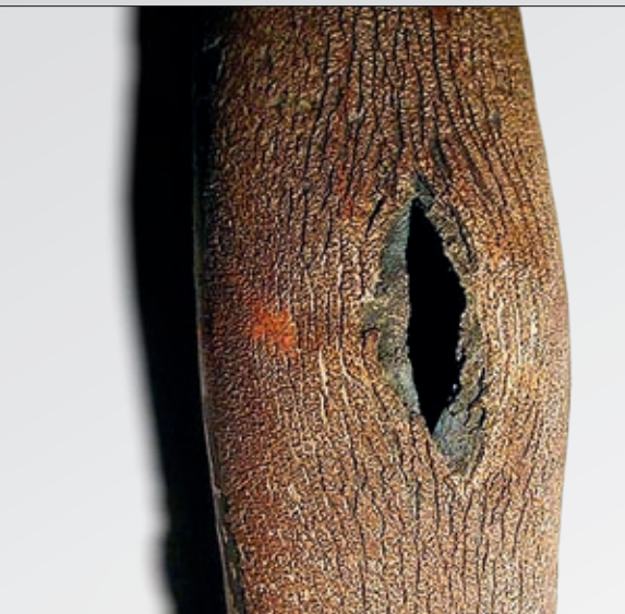
Stålrør med højt krom-indhold har dannet Z-fase ved 650 °C og er brudt sammen.
